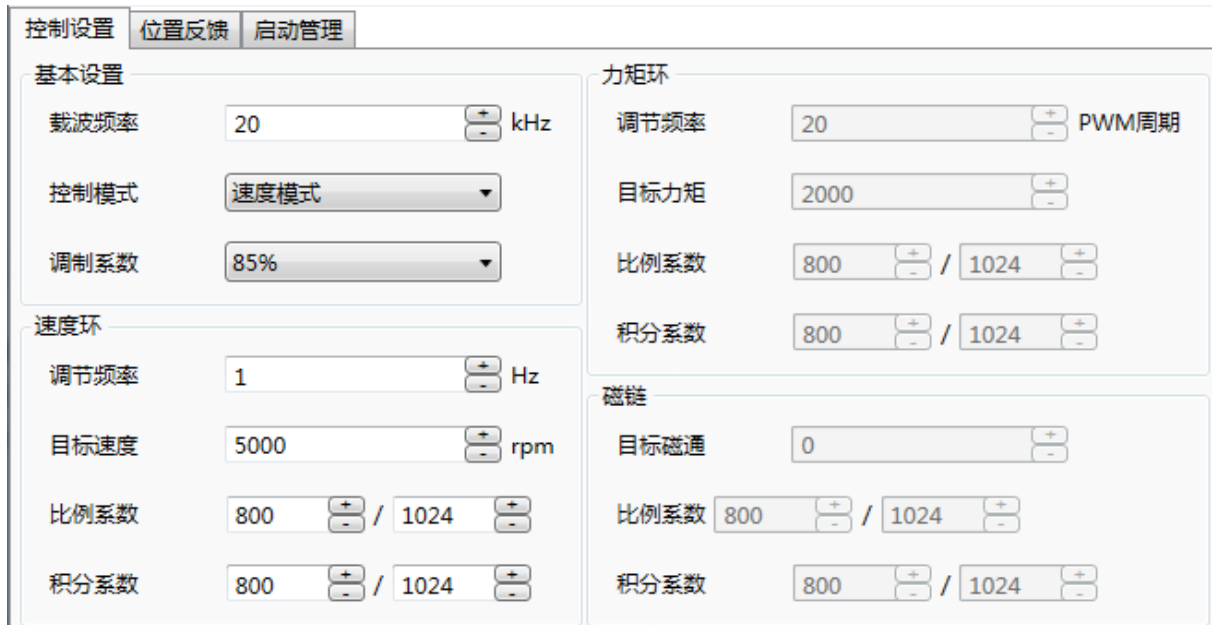
图 2-15 速度环、力矩环及磁通调节设置
